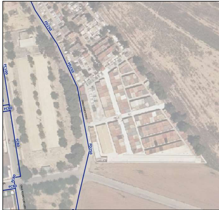
Figura 3. Red de agua potable existente en la zona del Camino del Cementerio.
