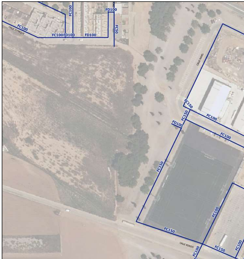
Figura 4. Red de agua potable existente en la zona de la C/Ronda.
